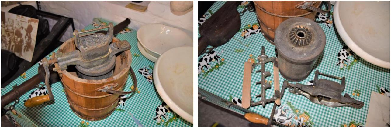
Au centre, une cuve reçoit la crème ou le jus de fruit. La glace pillée et du gros sel sont ajoutés entre la cuve centrale et le seau extérieur. Il faut un peu d'énergie pour tourner la cuve une vingtaine de minutes et ... les lois de la physique font le reste !
